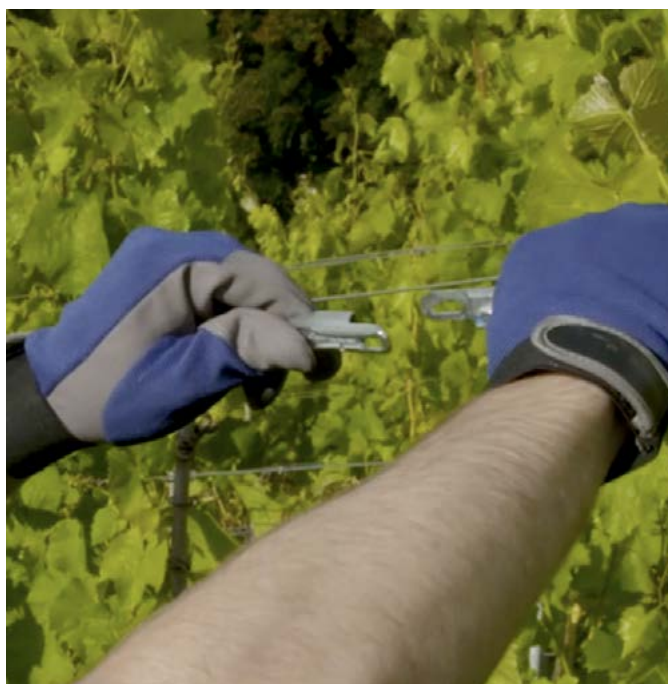
Spojka je svým provedením rozdělena na dvě části, do nichž nasunete konce přetrženého drátu; obě poloviny spojky poté jednoduše přitáhnete k sobě a pomocí mechanismu spojky snadno napojíte.
