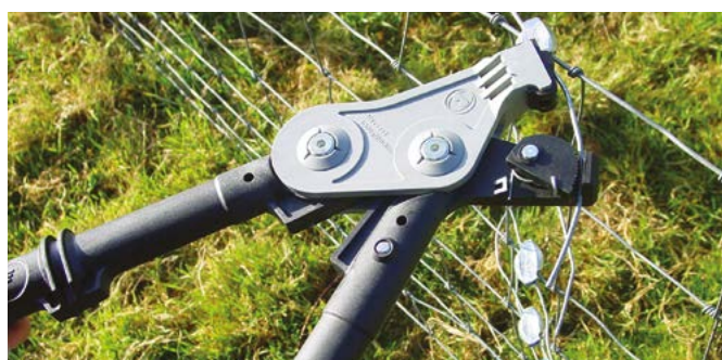
Nahoře: Napínání pomocí kleští Torq Tool 5
