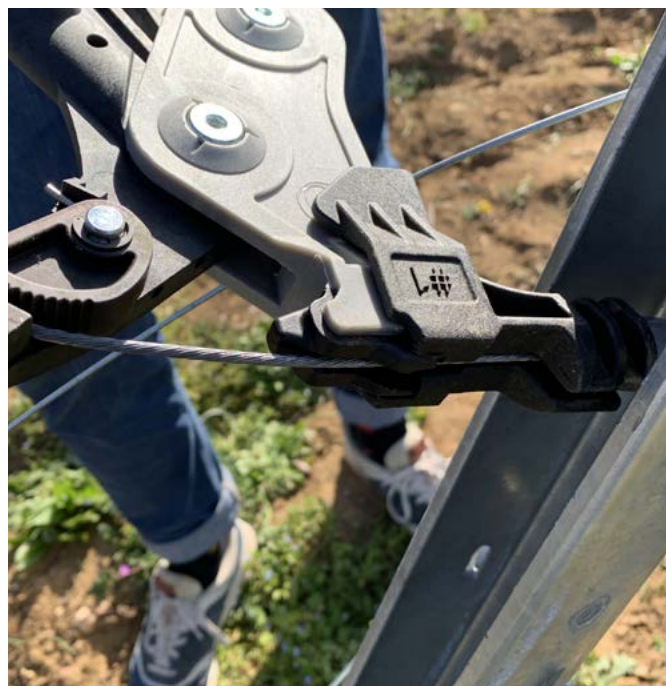
Adaptér - umožňuje napínání spojky uvnitř sloupku pomocí kleští.
